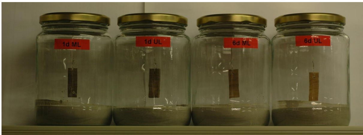
Foto 3. Serie A. 0.125% NH 3 och Byggcement. 1d ML= 1 dygn med lock, 1d UL= 1 dygn utan lock, 6d ML= 6 dygn med lock, 6d UL= 6 dygn utan lock. Fotografering har skett 1 dygn efter att ekbiten placerats i burken.
