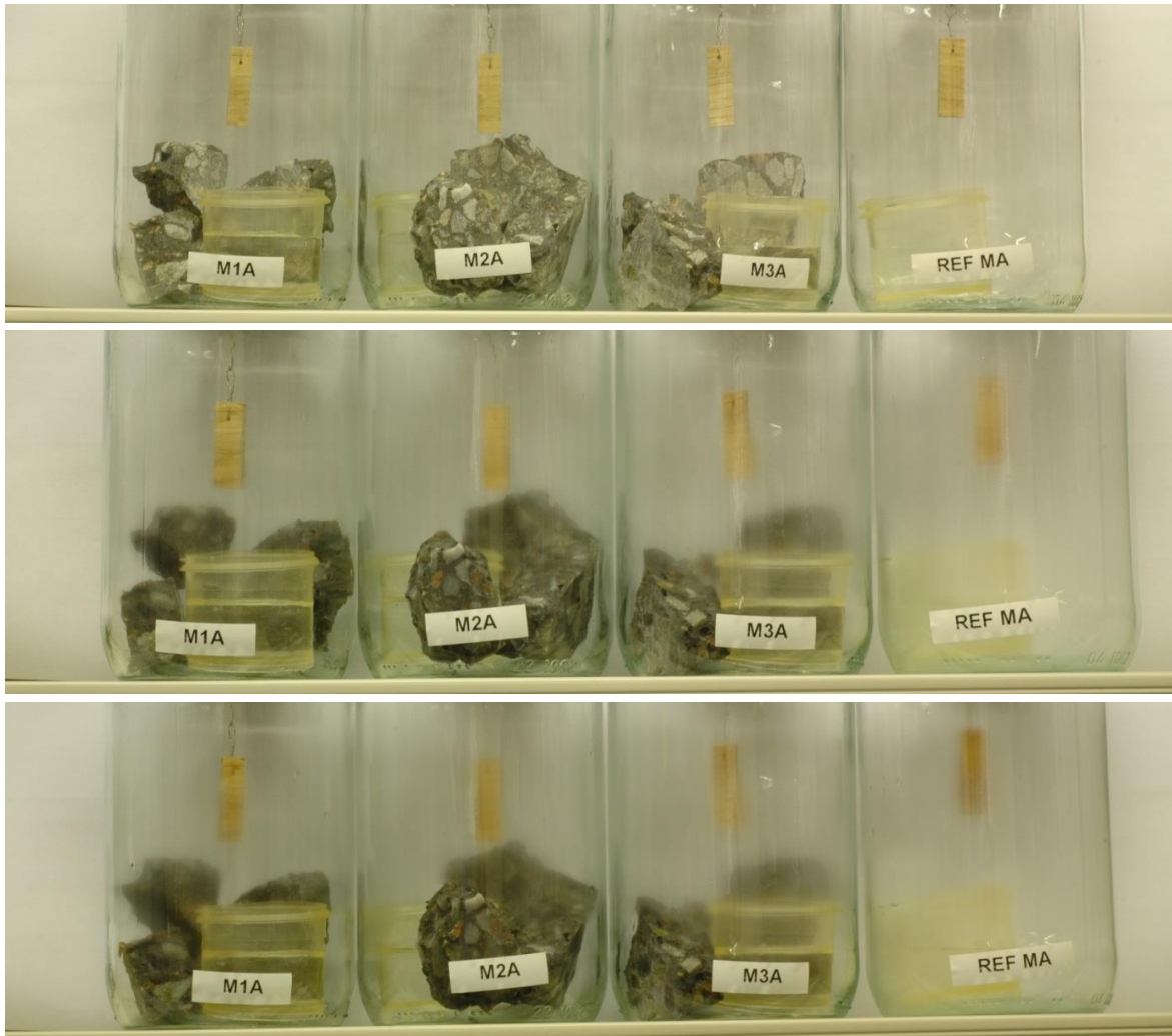
Foto 18. Övre bild direkt efter krossning, mittenbild efter två månader, undre bild efter fyra månader. Ref innehåller ingen betong utan enbart vatten motsvarande 100%.
