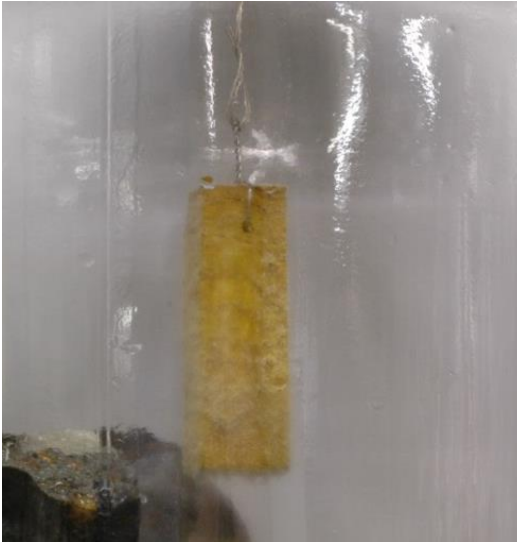
Foto 23. Närbild på ekbit som exponerats för Bascement och flytmedel med kvävehaltiga ämnen i två månader. Tydlig mögelpåväxt men ingen direkt missfärgning.
