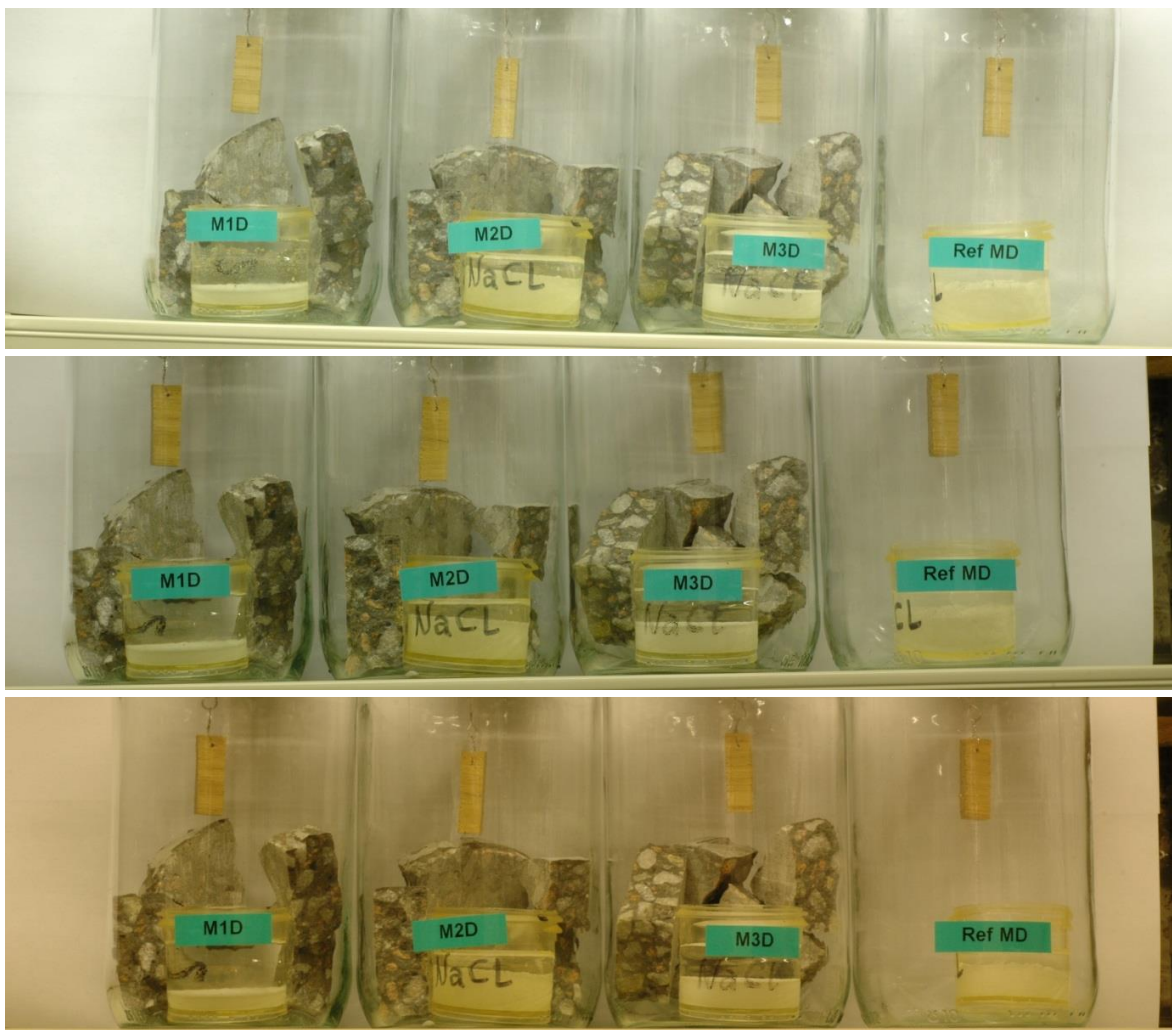
Foto 15. Övre bild direkt efter krossning, mittenbild efter två månader, undre bild efter fyra månader. Ref innehåller ingen betong utan enbart saltlösning motsvarande 75% RF.
