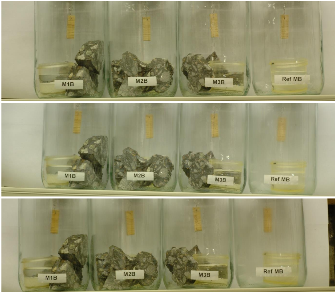
Foto 17. Övre bild direkt efter krossning, mittenbild efter två månader, undre bild efter fyra månader. Ref innehåller ingen betong utan enbart saltlösning motsvarande 97 % RF.
