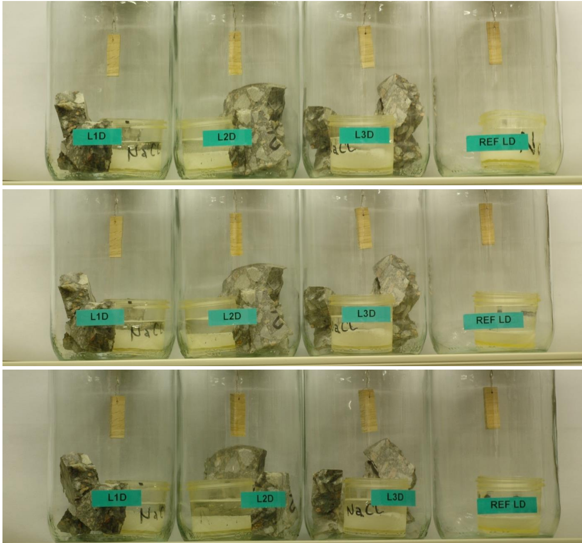
Foto 11. Övre bild direkt efter krossning, mittenbild efter två månader, undre bild efter fyra månader. Ref innehåller ingen betong utan enbart saltlösning motsvarande 75 % RF.
