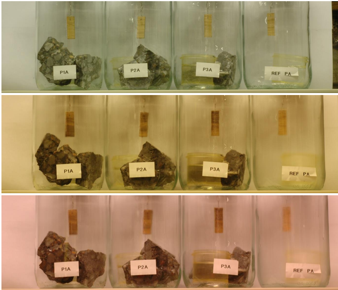
Foto 28. Övre bild direkt efter krossning, mittenbild efter två månader, undre bild efter fyra månader. Ref innehåller ingen betong utan enbart vatten motsvarande 100 % RF.
