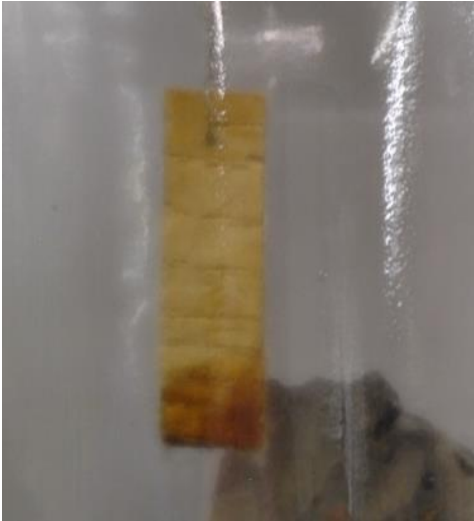
Foto 24. Närbild på ekbit som exponerats för Bascement och flytmedel med kvävehaltiga ämnen i två månader. Tydlig mögelpåväxt och missfärgning främst i den undre delen av provet.
