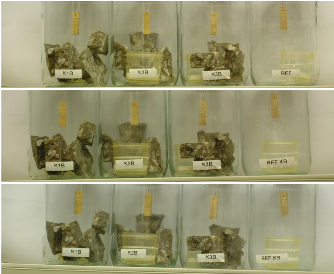
Foto 9. Övre bild direkt efter krossning, mittenbild efter två månader, undre bild efter fyra månader. Ref innehåller ingen betong utan enbart saltlösning motsvarande 97 % RF.
