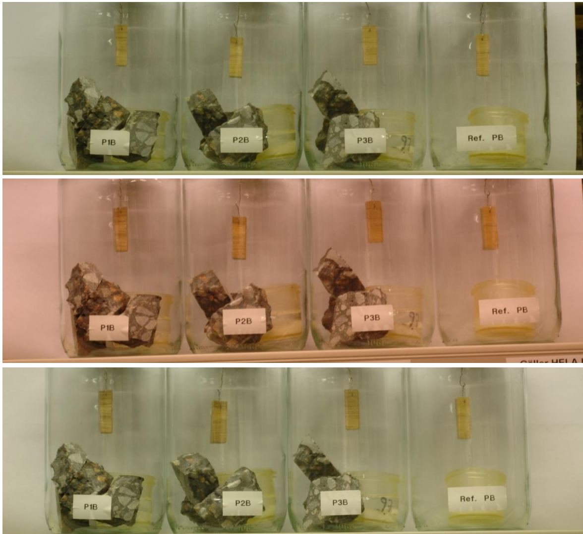
Foto 27. Övre bild direkt efter krossning, mittenbild efter två månader, undre bild efter fyra månader. Ref innehåller ingen betong utan enbart saltlösning motsvarande 97 % RF.
