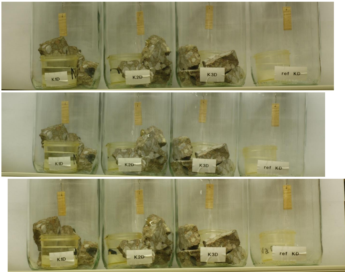
Foto 7. Övre bild direkt efter krossning, mittenbild efter två månader, undre bild efter fyra månader. Ref innehåller ingen betong utan enbart saltlösning motsvarande 75 % RF.
